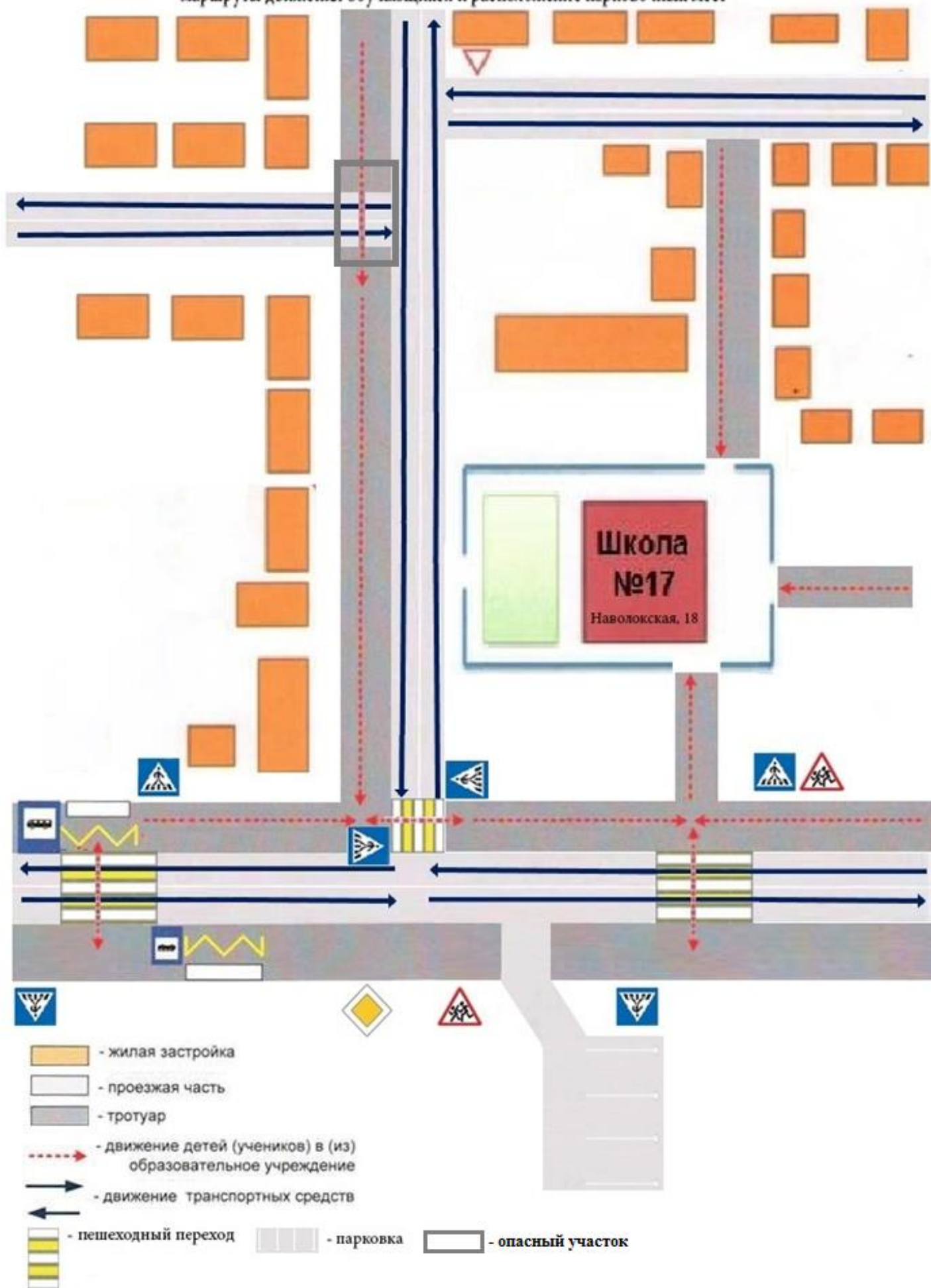
2. Схема организации дорожного движения в непосредственной близости от ОО с размещением соответствующих технических средств, маршруты движения обучающихся и расположение парковочных мест
